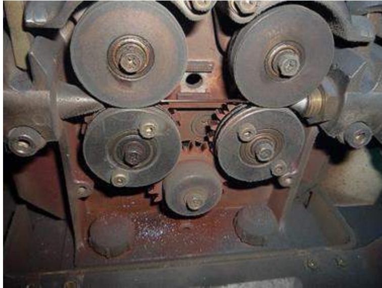
▲ 図 023-02 4ロール送給装置における切粉発生例（中間ワイヤガイドが取り外されている）
