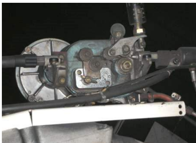
図 028-01 ロボットアーム上のワイヤ送給装置 ■送給装置周りが汚れている 「きれいにしましょう！」
