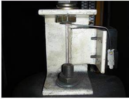
▲ 図026-03 リミットスイッチ+レバー式ワイヤ検出器 (ワイヤにキズを付けやすく、銅粉発生しやすい)
