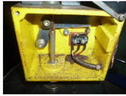
▲ 図026-04 ローラ式ワイヤ検出器の例 (銅粉発生が多くみられる)
