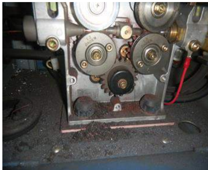
▲ 図023-01 4ロール送給装置における銅粉などの発生例（ロール下方に銅鉄粉が落下、堆積）
