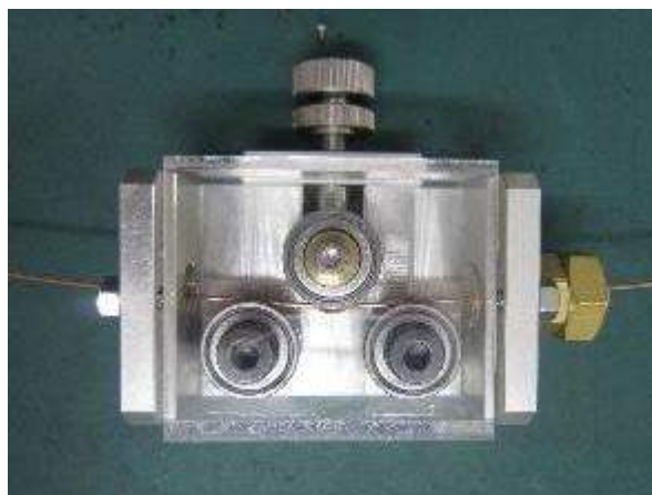
▲ 図 027-04 送給装置入口側取付け「3点ワイヤ矯正器」 (矯正量と矯正方向を適正に設定して下さい)
