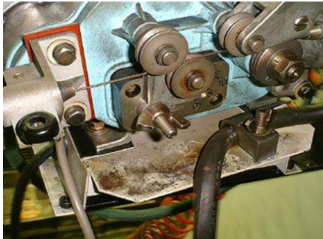
図 028-03 4WD送給装置周りの銅粉、鉄粉 ■直ちに異常と判定し、原因と発生箇所を見つけ対策してください。
